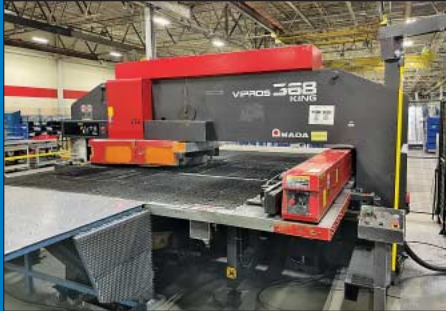
30 Ton Amada Vipros 268 King CNC Turret Punch Press
