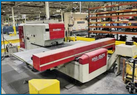
30 Ton Nisshinbo HIQ 1525 CNC Turret Punch Press
